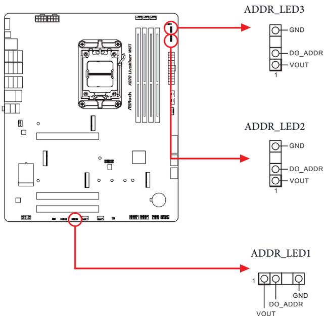
アドレスابل RGB LED ストリップをマザーボード上のアドレスابل LED ヘッダー (ADDR\_LED1 / ADDR\_LED2 / ADDR\_LED3) に接続します。
